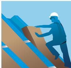
După instalarea și fixarea barierei de vapori, începeți să instalați vata minerală cu o lățime mai mare cu minim 10 mm (1 cm) decât distanța dintre căpriori, pentru a garanta o fixare sigură.
