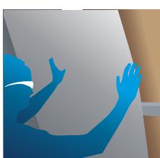
Aplicați bariera de vaporî peste profilele metalice, apăsând cu femitate în zona benzilor dublu-adezive pentru a asigura o lipire corespunzătoare.
