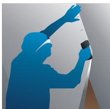
Fixați bariera de vapori cu capse de 8-10 mm, cu o distanță între capse niciodată mai mare de 30 cm.
