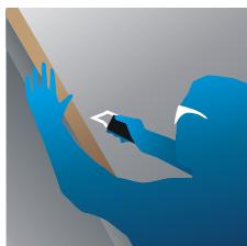
Odată ce ultimul strat de tencuială este aplicat, utilizați un cuțit ascuțit pentru a tăia bariera de control a vaporilor în exces și finisați îmbinările.
