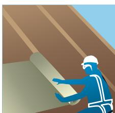
După instalarea ultimului strat de izolație din vata minerală, aplicați membrana Homeseal LDS 0,04 Fix Plus, foarte rezistentă la vânt și intemperii, care protejează izolația și clădirea împotriva pierderilor de căldură, împiedicând în același timp infiltratiile din exterior.
