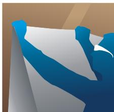
După montajul vatei minerale între și peste căpriori, derulați bariera pentru controlul vaporilor Homeseal LDS și așezați-o cu partea imprimată către interiorul încăperii.
