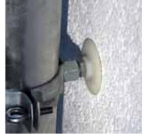
Durch die einteilige Dübelkonstruktion liegt der Dübel immer an der Wand an und **dichtet optimal** ab. Die **Einstellung des Abstandes** zur Wand erfolgt einfach durch Herausdrehen des Spezialstifts.
